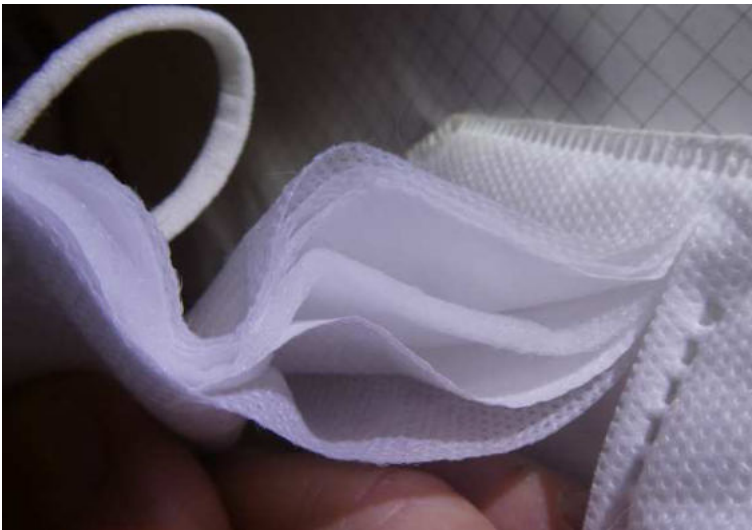
Bild 2: Maske – Schnittdarstellung – 6 Schichten
